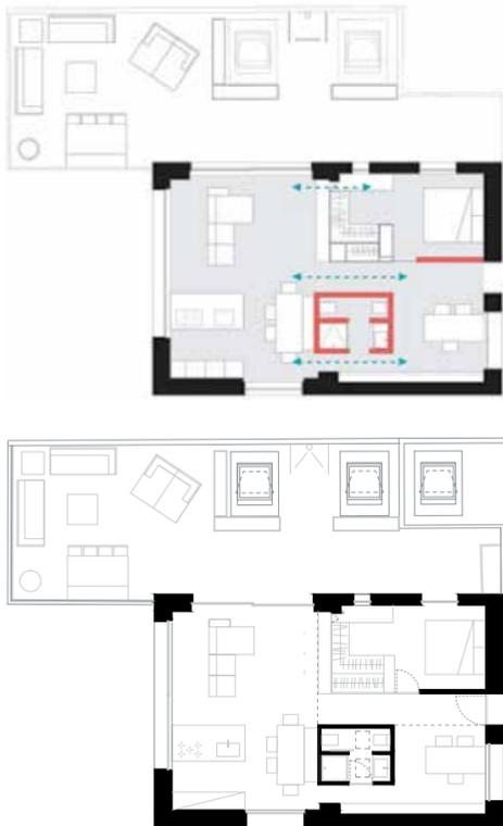
In alto, l'ampio terrazzo dell'appartamento. La pianta di progetto mostra l'uso ridotto al minimo delle murature (in rosso) e massimo sfruttamento dei lati finestrati con visuali (freccie verdi) ottenute grazie allo scostamento del volume del bagno dal perimetro e da un'apertura interna tra la camera e il soggiorno.
