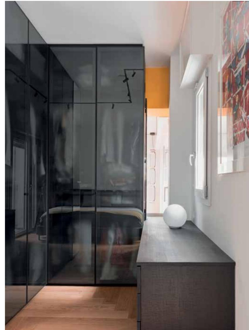
Gli arredi su misura, realizzati con melaminici e truciolari forniti dal Gruppo Bonomi Pattini, sono finiti con rivestimenti dall'aspetto materico e realistico: effetto tessuto e lamiera di ferro effetto calamina.
